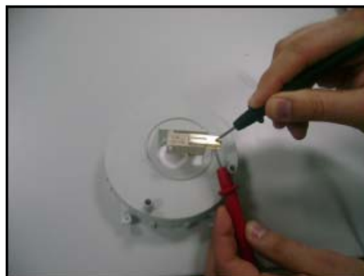
0 ohm (sans eau = interrupteur inactif)
