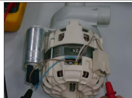
Mesure enroulement secondaire (câble bleu) 126 +/- 7
