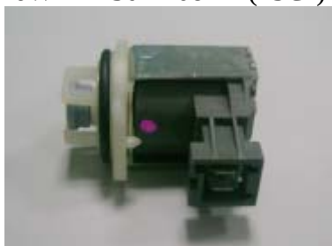
Electrovanne régénération 6W - 4130 \pm 10\Omega ( 25^\circ )
